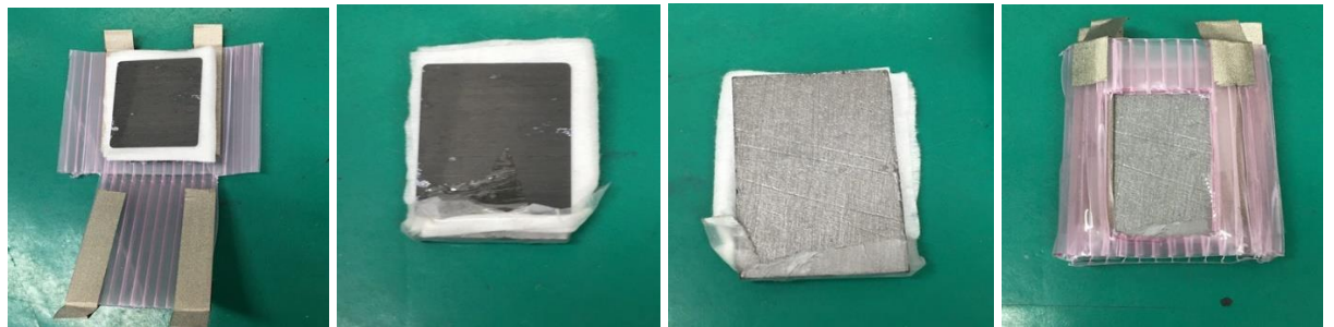
兩電極間以揮發後的酒精 兩電極底部以止洩薄膜處理 避免電極於底部接觸 以 pp 板封住，鹽水可於頂部注入，須計算注入的定量體積 棉片當絕緣及鹽橋
