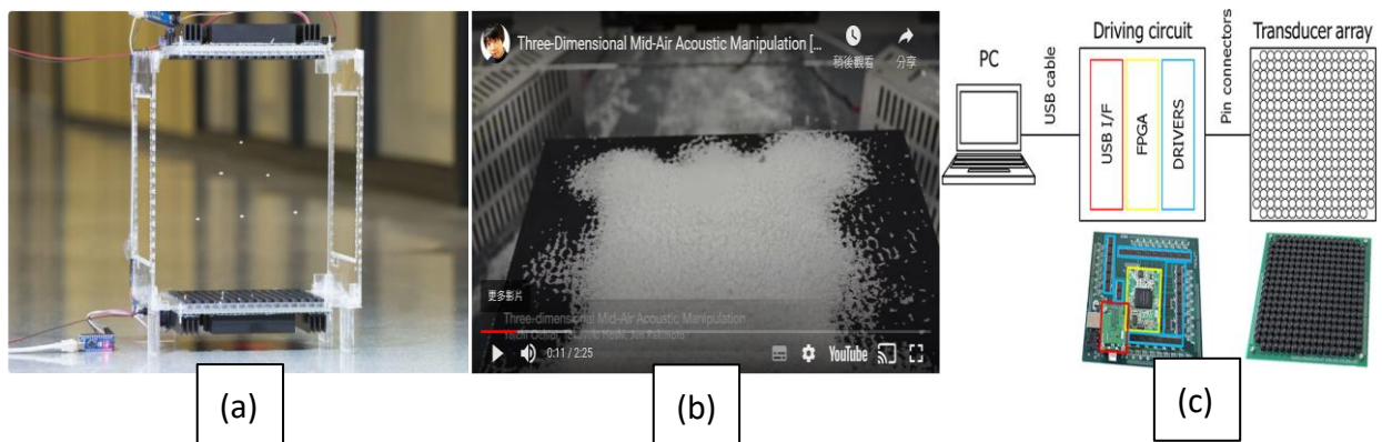
圖1. (a)懸浮在空中的保麗龍球[1]，(b)東京科學家--隨音樂起舞的物體[2]，(c)內部的電路結構[3]。
