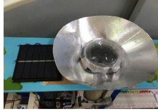
集光反射板及集光4mm 焦距菲涅爾透鏡
