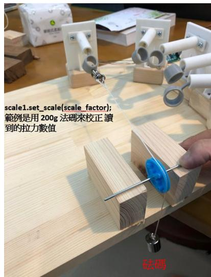
圖 6. 拉力器校正
