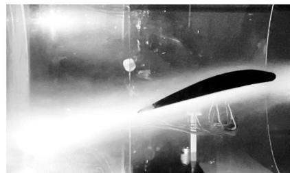
圖20 低攻角機翼流場分布情形
