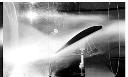
圖21 高攻角機翼流場分布情形
