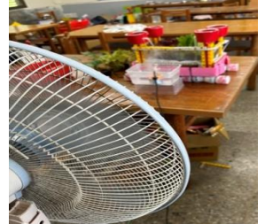
超音波霧化器模擬白天吹向生態浮板植栽夾帶水氣的海風實驗
