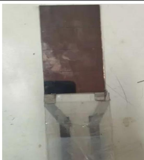
這則是我們將電池進一步密封後，再將電極接出並連接太陽能板以方便充電觀察的密封電池。膠帶要盡可能地把縫隙都封上，也要注意不能使電解液外漏至導電膠帶，會增加其電阻進而影響效能。
