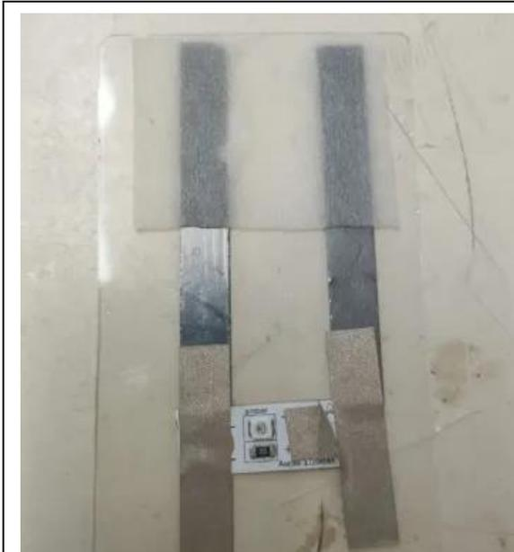
這是我們做出來的紙片電池，具體方式是在塑膠板上貼兩片碳片，中下方放個LED燈以方便測量其是否有電極放電，並且以導電膠袋連接，再以導電膠帶做一個觸碰式開關，最後放上棉布。
