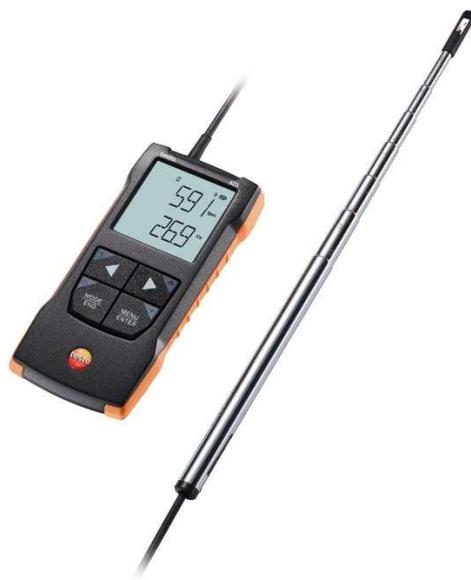
圖5 熱線風速計[7]，偵測溫度造成的電阻變化，並換算成風速。本裝置價格約3500元。
