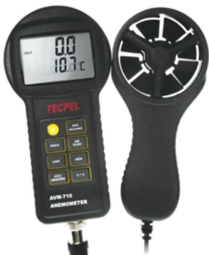
圖3 葉輪式風速計[5]，由葉片旋轉帶動內側馬達轉動，透過電壓換算為風速。
