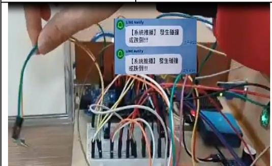
第二代模組改良版~透過「三軸加速度感測器」（如左圖），偵測感測器數值的變化範圍，如果突然變大或變小代表可能發生跌倒或碰撞，會立即觸發「蜂鳴器」發出警報聲響並同步發送 line Notify 自動化即時訊息傳送通知親友群組，進行緊急應變。
