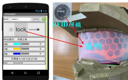
圖15、RFID解鎖後調光膜透明
