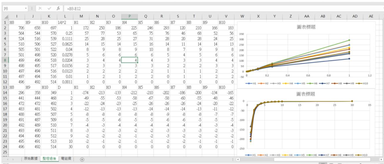
我們也用電磁鐵以不同電流輸入並且記錄，符合磁場強度與電流成正比。
