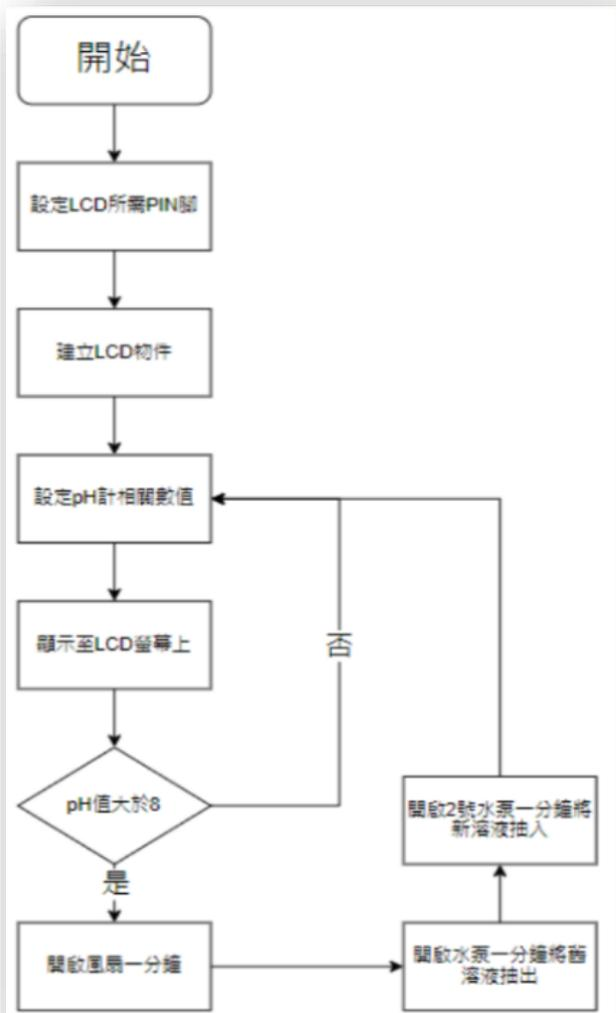
利用程式整合 pH 值檢測器、LCD 螢幕、風扇與抽水馬達，以達到自動排除甲醛的效果
