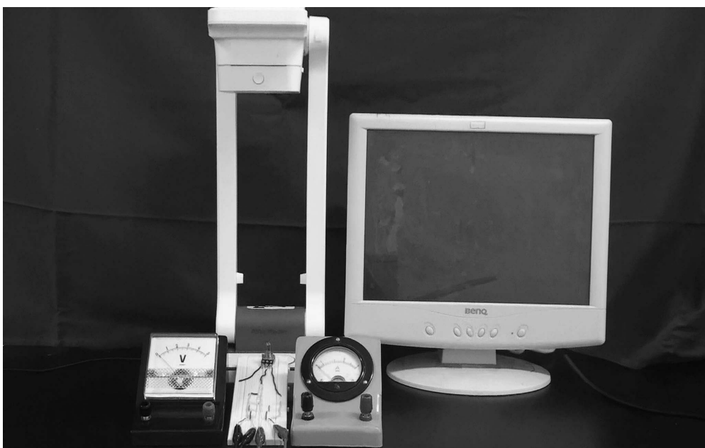
圖 3：實驗裝置圖：圖的左上方為實物投影機，右上方為螢光幕，下方為白色的麵包板，左右各為伏特計和安培計。
