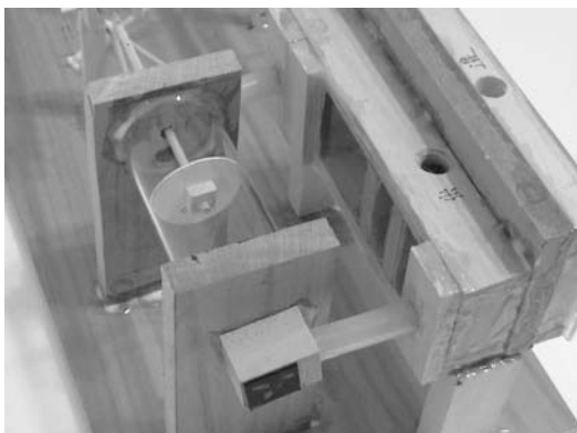
圖 2：玻璃汽缸中的紙活塞與連桿連接在一起，汽缸一端用木板封住，木板中間有直徑 4.5mm 的小孔，下方有一通氣的大孔；汽缸另一端用也木板封住，木板中間有一通氣的大孔。兩大孔分別用矽膠管與分流盒連通。
