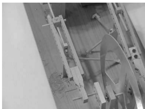
圖 7：音叉狀連桿的實物攝影。兩側小孔可減輕重量。
