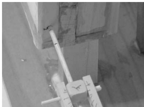
圖 6：口字形木框的連桿特寫。此直徑 4 mm 的連桿，從分流盒夾層側邊木條下方的小孔（直徑約 4.5mm）穿出。
