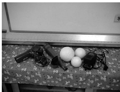
圖 5：開放型風洞套件：左 1 為改裝後的吹風機，左 2 為改變出風口面積的管狀物，右 1 為變壓器。
