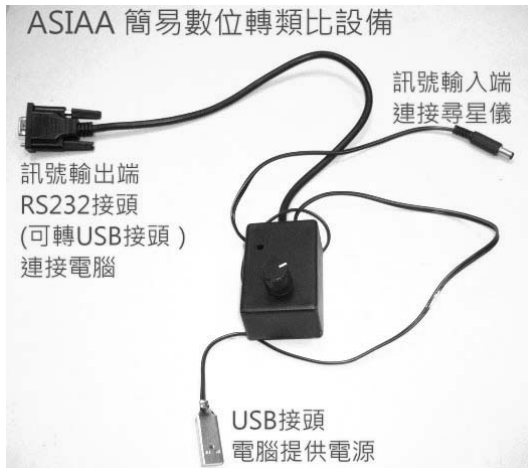
圖 4：自製的 AD 轉換器，用以連接衛星搜尋器和電腦
