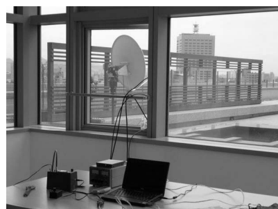
圖 11：上圖是接上馬達的衛星天線。下圖是整合商業產品進行遠端控制電波天線(戶外)，桌面上放著電腦、衛星搜尋器以及馬達控制器。
