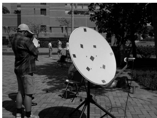
圖 9：天線盤面貼上可反光的鋁箔紙，藉此做為天線對準太陽的工具
