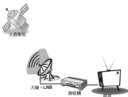
圖 1：TVRO(Television Receive Only)示意圖，針對各衛星所傳送的訊號，嘗試加以接收和解調但並不發送
