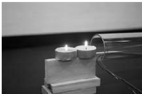
圖 5 (a)：共振腔發出的聲音在管口引起氣流。
