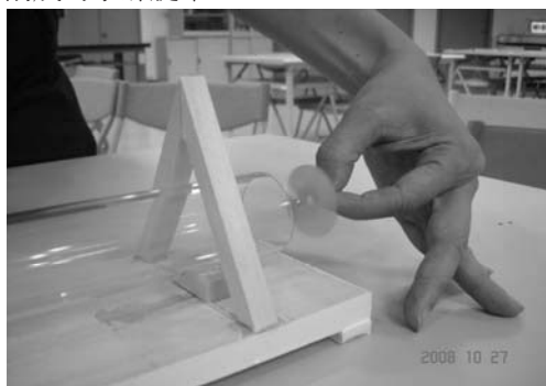
圖 5 (C)：在管口引起的氣流也能推動鋁片製成的小螺旋槳。
