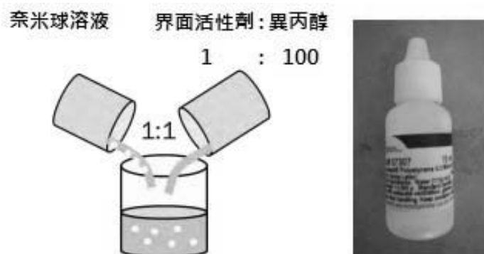
圖 1：所調配之溶液比例為「異丙醇與界面活性劑：奈米球溶液 = 1:1」。右附圖為聚苯乙烯奈米球原液(Polybead® Microspheres 1 \mu m)
