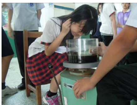
圖 5：學生解說利用拉胚用的轉輪製造拋物面鏡的放大虛像。
