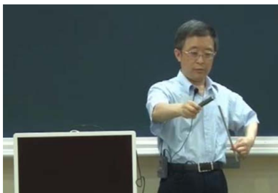
圖 6：老師手捏距端點四分之一棒長處，敲擊端點，金屬棒發出更高頻率的聲音。
