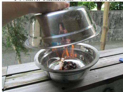
圖 12：利用熱膨脹使內部產生低壓狀態。
