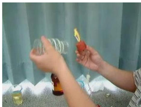
圖 5：點火後等火焰較小時迅速塞入廣口瓶中。
