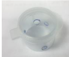
圖 19：將顏料盒打洞，兩側進排水洞，中央進排氣洞。
