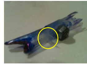
圖 22：插入吸管小片防止發泡錠因傾斜而滑落。
