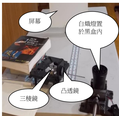
圖 5：實驗設備擺置圖，右下方為被虎鉗固定至於黑盒內的白熾燈。
