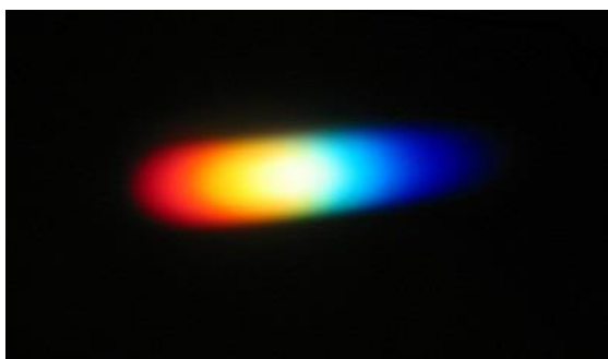
圖 10：44 瓦時之光譜，屏幕距離 0.8 公尺，輻射最強處在中間黃藍交接處。
