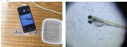
圖 4：左圖可見手機擺放在手機顯微鏡台上，利用手機的相機就能做觀察魚苗，塑膠盒內裝的即是斑馬魚苗。右圖為相機拍攝的斑馬魚魚苗。
