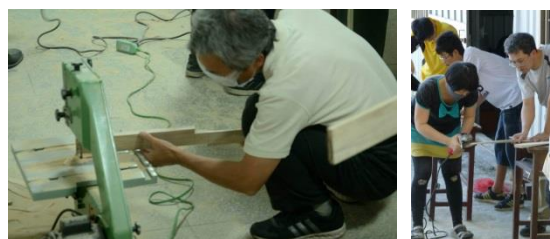
圖 5：先用帶鋸機大致切削掉多餘的木材，再用砂輪機做較細微的加工，最後用砂紙做最後的修整。
