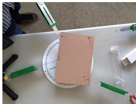
圖 2：利用紙板做四力平衡實驗。
