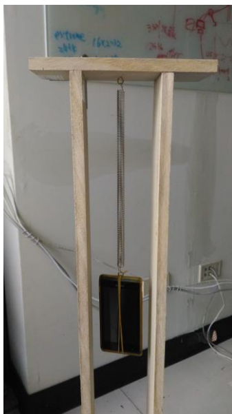
圖 4：將手機掛在彈簧下方，向下拉扯後放手，手機呈現簡諧振盪
