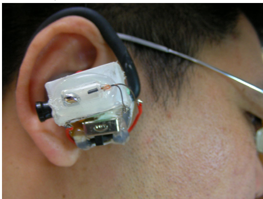
圖 7：戴上後旋轉電池盒即可輕易調整靈敏度
