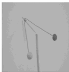
圖8d：牙籤上繞有二端有黏土球的鐵絲(左);改變鐵絲纏繞的位置高低(中); 改變鐵絲張開的角度。
