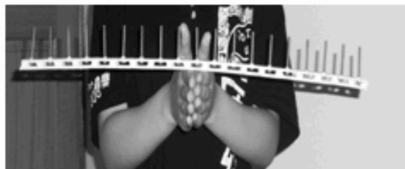
圖 4：自製長條棒可放入螺帽改變重心位置
