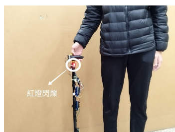
圖二十七、發生異常運動狀態或緊急狀況,紅燈閃爍
