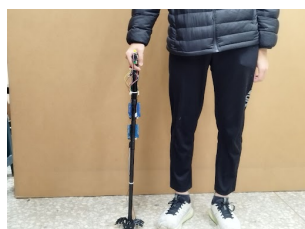
圖二十五、拐杖支撐功能示意圖
