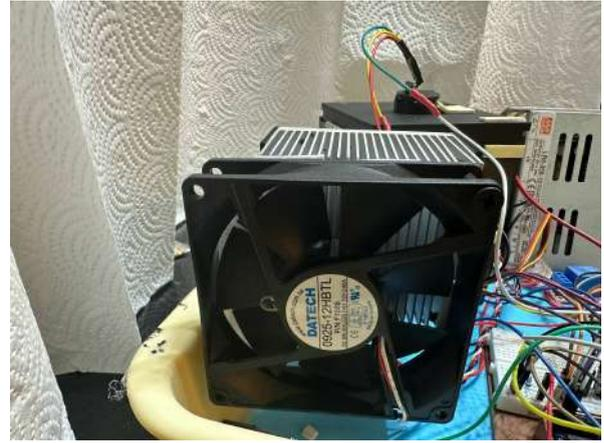
圖6:製冷晶片背後的散熱風扇
