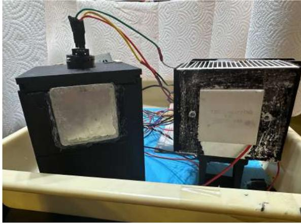
圖5:鋁板(左)和製冷晶片(右)
