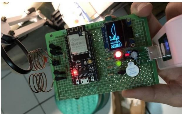
圖 15 將電路製作在洞洞板上
