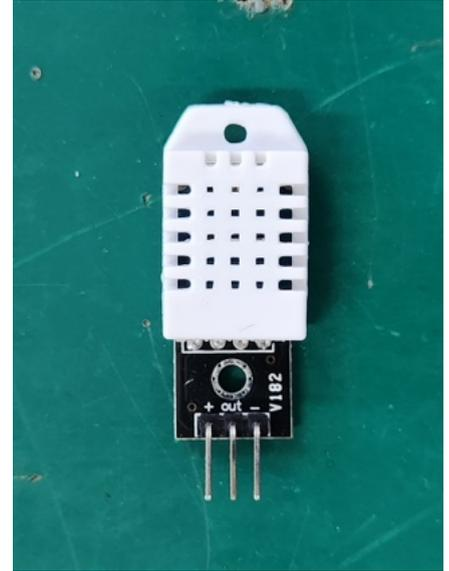
圖七、塑膠微粒過濾模組 | 圖八、水質感測模組 | 圖九、DHT22 溫濕度感測器
