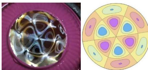
圖 6：頻率為 46 Hz 的圓形肥皂膜駐波及模擬圖形
